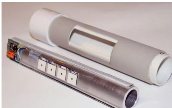
Obrázek 23 Termoelektrická baterka na lidské teplo [18]
