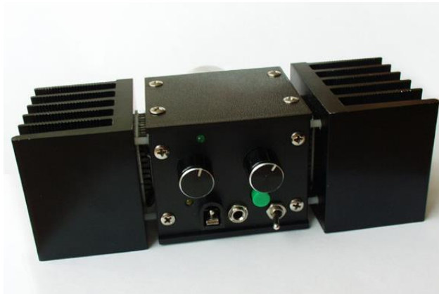
Obrázek 33 CCD kamera chlazená dvěma Peltierovými články [26]
