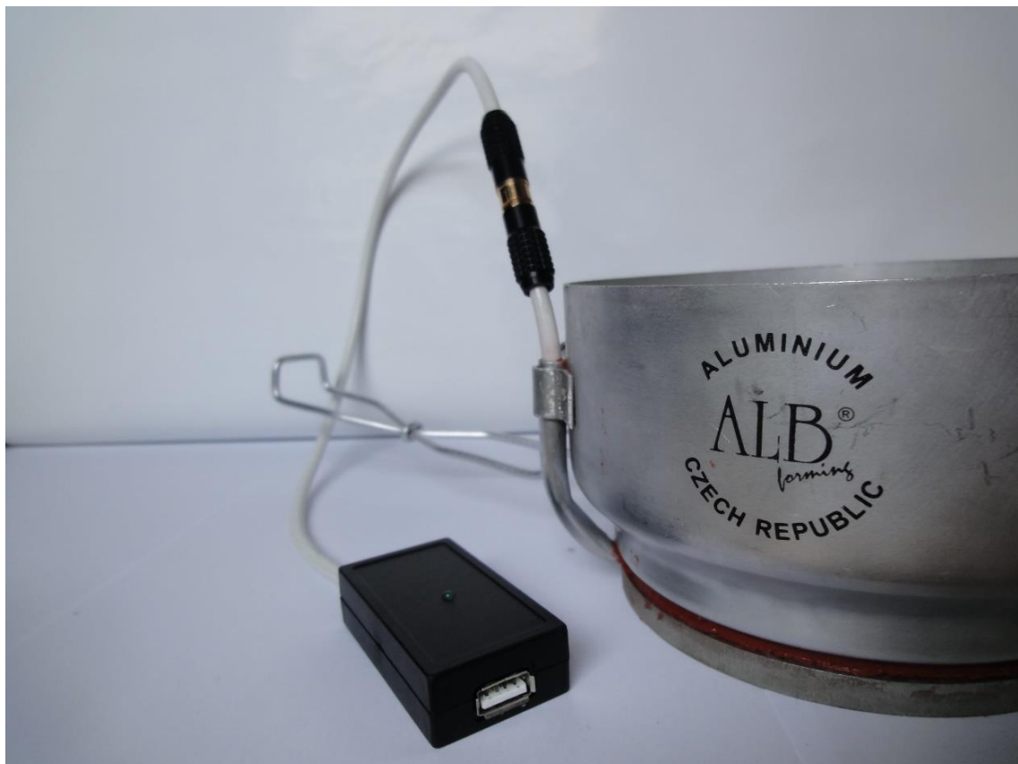
Obrázek 48 Termoelektrická nabíječka s DC-DC měničem
