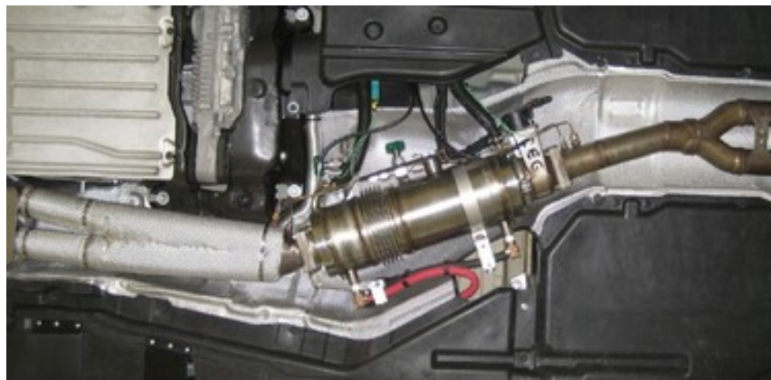
Obrázek 26 Termoelektrický generátor instalovaný ve voze BMW X6 [14]
