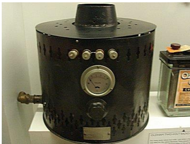
Obrázek 16 První komerční termoelektrický generátor – Thermattaix [15]
