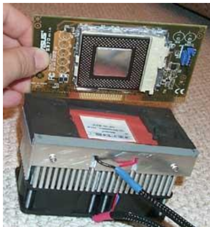
Obrázek 32 Procesor chlazený Peltierovým článkem [24]
