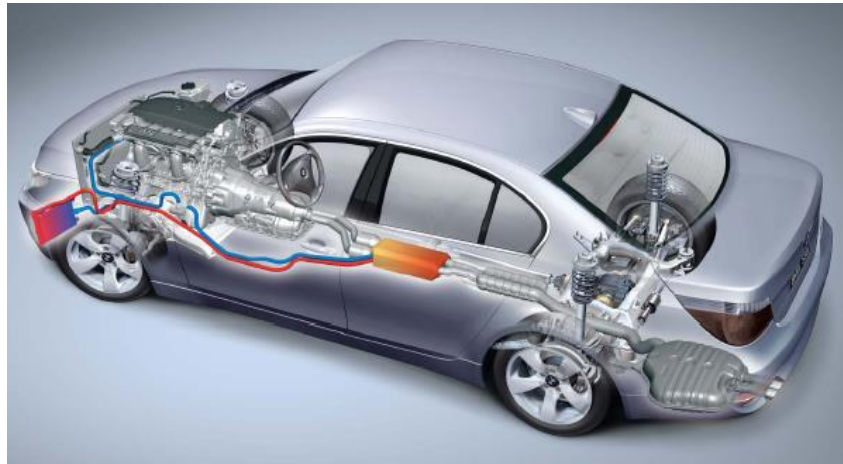
Obrázek 25 Využití odpadního tepla u automobilů [19]
