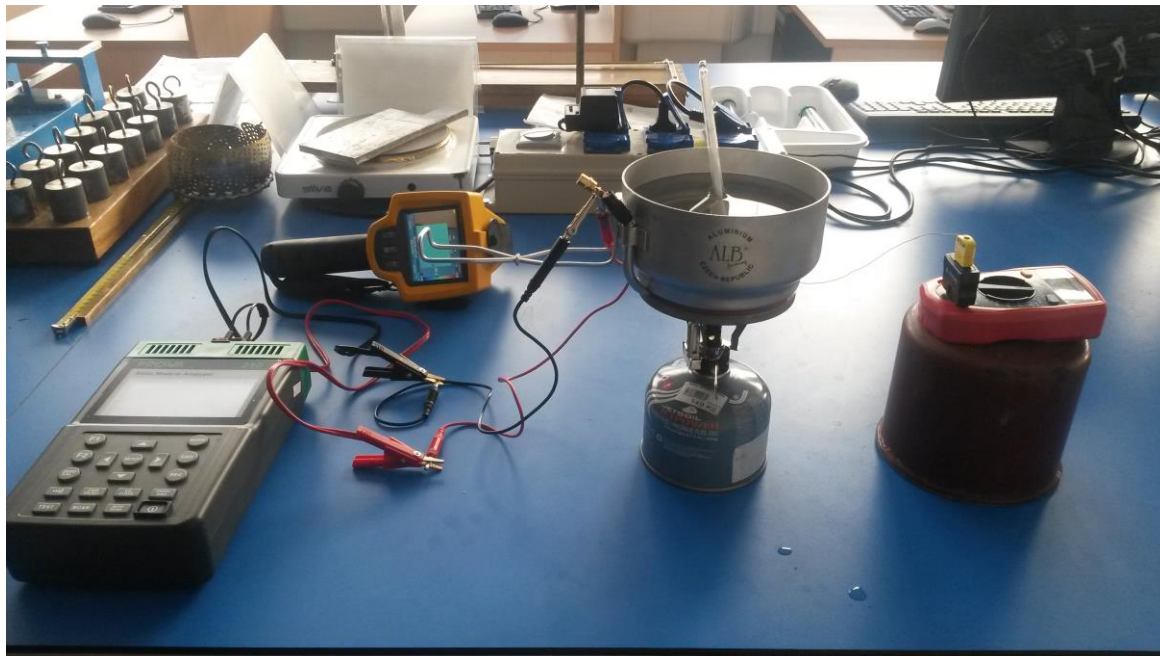
Obrázek 49 Měření výkonových parametrů termoelektrické nabíječky
