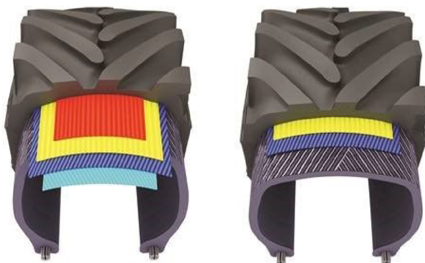
Obr. 22: Radiálna (vľavo) a diagonálna (vpravo) koštrukcia plášťa pneumatiky [40]
