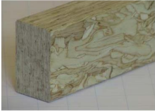
Obr. 16: LSL a jeho použití na nosník (Augustin a kol. 2008)
