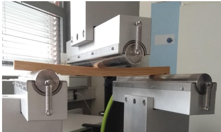
Obr. 35: Modřínové zkušební těleso zatížené statickým tříbodovým ohybem
