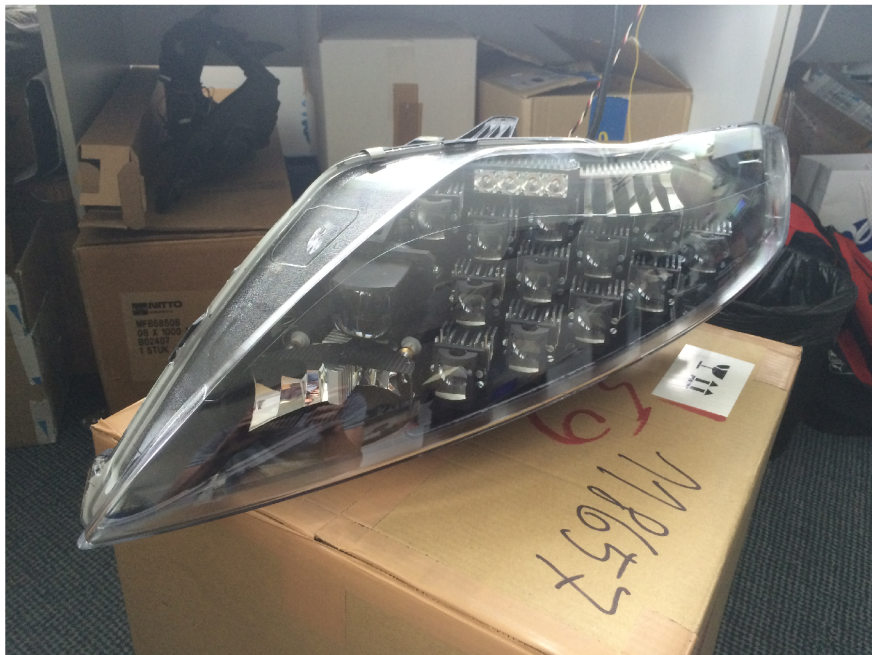
Obr. 4.9: Prototypový světlomet "matrix", model Ford Mondeo
