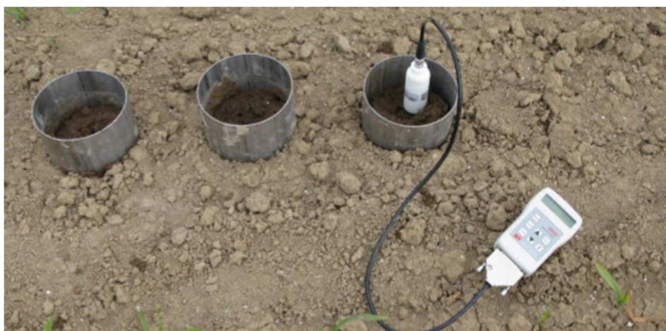
Obrázek č. 5: Měření hydraulické vodivosti
