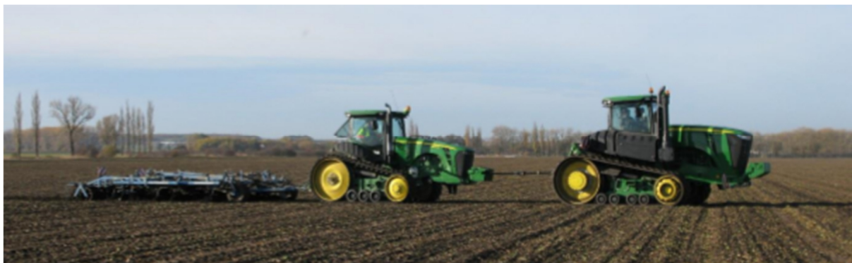
Obrázek č. 6: Měření tahového odporu
