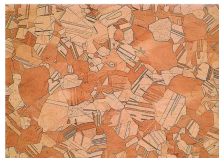
Obr. 16: Změna materiálu po působení tepla
