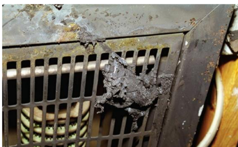
Obr. 6: Zbytky spálené tkaniny na přímotopu
