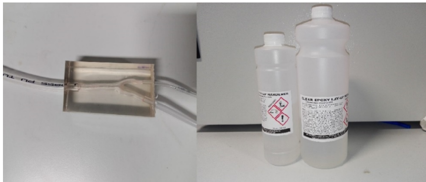
Obr. 15 a) hotový epoxidový model b) materiál pro výrobu modelu [foto autor]
