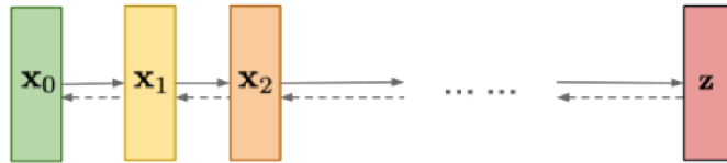
Obr. 1.9: Difuzní model postupné přidání šumu a následné odebrání při opačném postupu[9]
