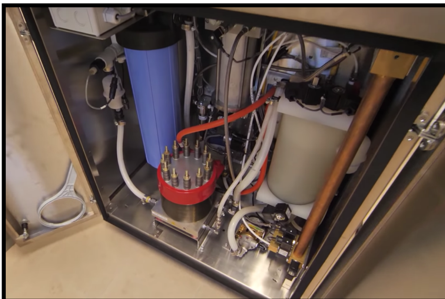
Obr. 5.3 Elektrolýzér s příkonem 7 kW, pripojený na fotovoltaickú elektrárňu – príklad lokálnej výroby vodíka pomocou OZE (pilotný projekt výroby zeleného vodíka, firma ÚJV Řež, Česká republika). [41]
