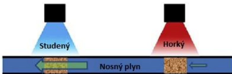
Obrázek 10: Kryogenní modulátor ve dvou tryskovém uspořádání [42]
