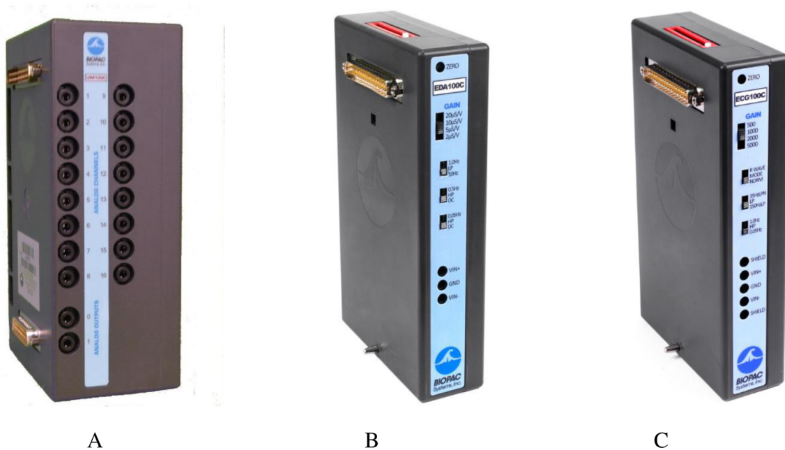
Obrázok 6 – A: Hlavný zosilňovač UIM 100C, B: Zosilňovací modul EDA typu EDA 100C, C: Zosilňovací modul ECG typu ECG 100C [21]
