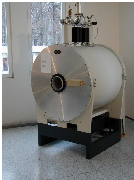
Obr. 0: Supravodivý magnet experimentálního spektrometru MRI používaný v IKEM s mag. indukcí 4,7 T
