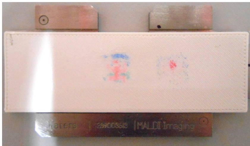
Obrázek 11 Polymerní model podložního sklíčka s otiskem barviv upevněný v držáku pro MALDI měření
