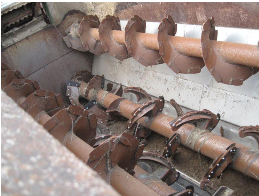
Obrázek 11 - Horizontální míchací šneky
