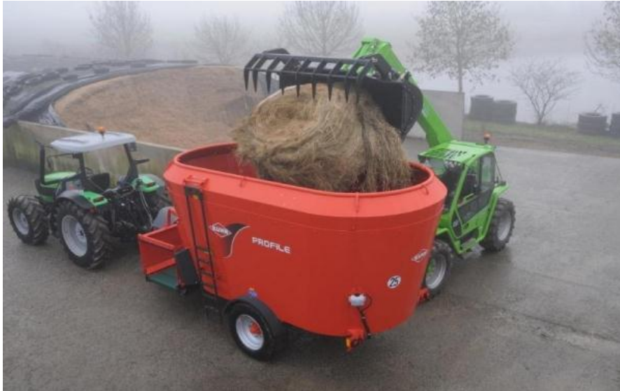
Obrázek 2 - Plnění MKV pomocí teleskopického nakladače
