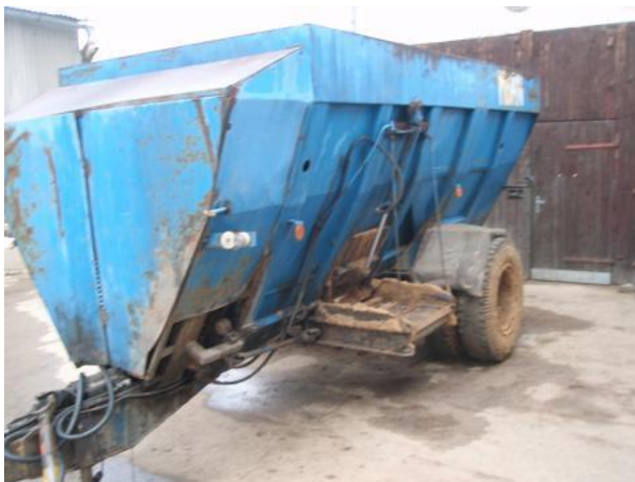
Obrázek 7 - Krmný míchací vůz Midan (pohled na provedení zakládacího ústrojí)
