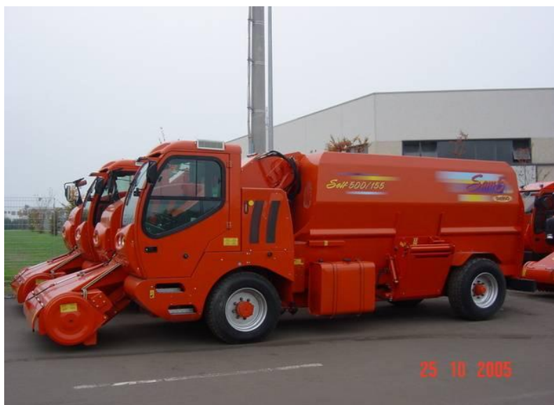
Obrázek 9 - Samojízdný míchací krmný vůz SEKO SAM 5 SELF
