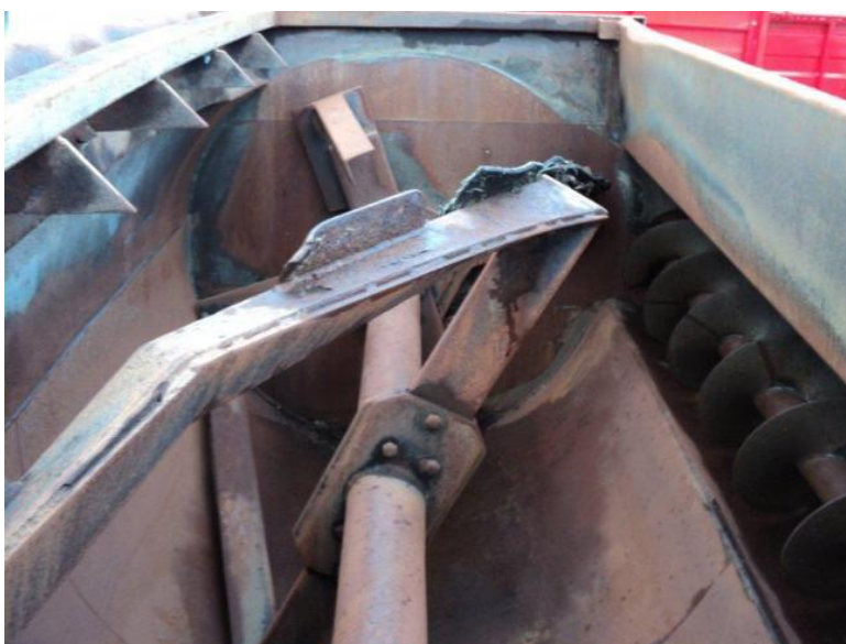
Obrázek 13 - Pádlové míchací ústrojí MKV Mišak.
