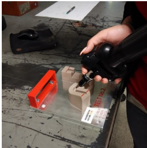
Obr. 31 Průběh kontrolního měření.
