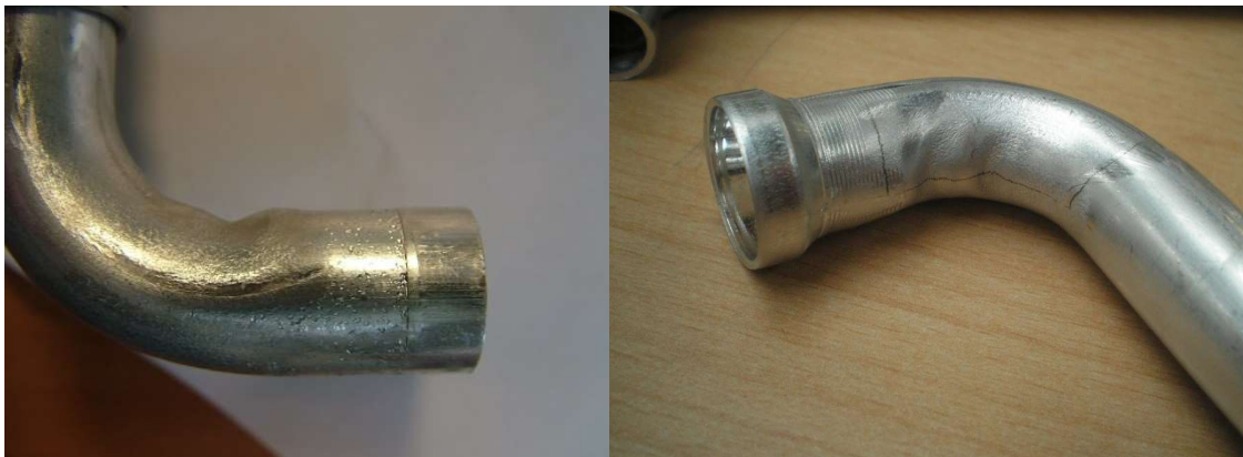
Obr. 10: Příklad zvlněných trubek ve firmě Denso Air Systems.
