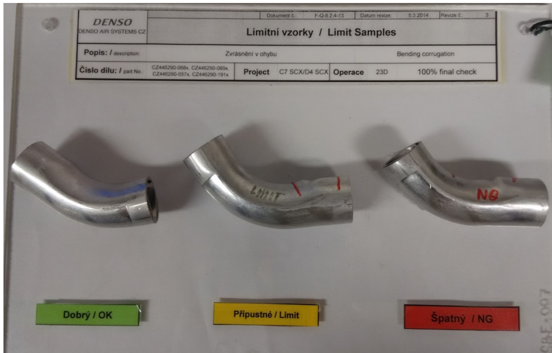
Obr. 11: Limitní vzorky zvlnění ve firmě Denso Air Systems.
