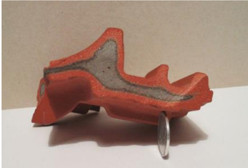
Obrázok 7: Detail lomovej plochy pálenej krytiny s redukčným jadrom v jeho okrajovej oblasti [10]
