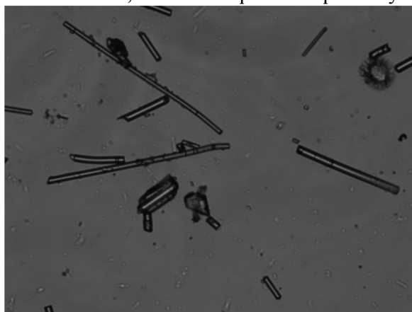
Obrázek 4.1 Ukázka nadrcené směsi 1, \times 200 , rozměr plochy obrázku 680 \times 520 \text{ }\mu\text{m}
