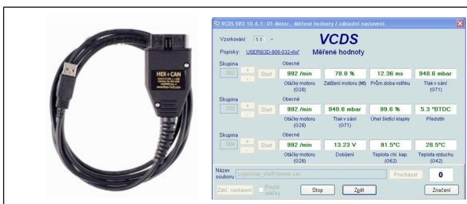
Obrázek 20 – Propojovací kabel HEX-CAN (vlevo) a program pro vizualizaci a ukládání dat VCSD (vpravo)
