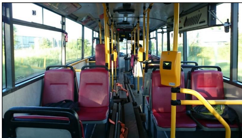
Obrázek 23 – Zatížení simulující obsazenost vozu
