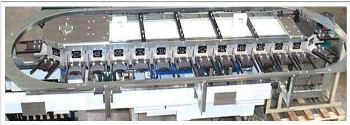
Obr. 9 – Řetězový zásobník vybavený řetězem s držáky [6]
