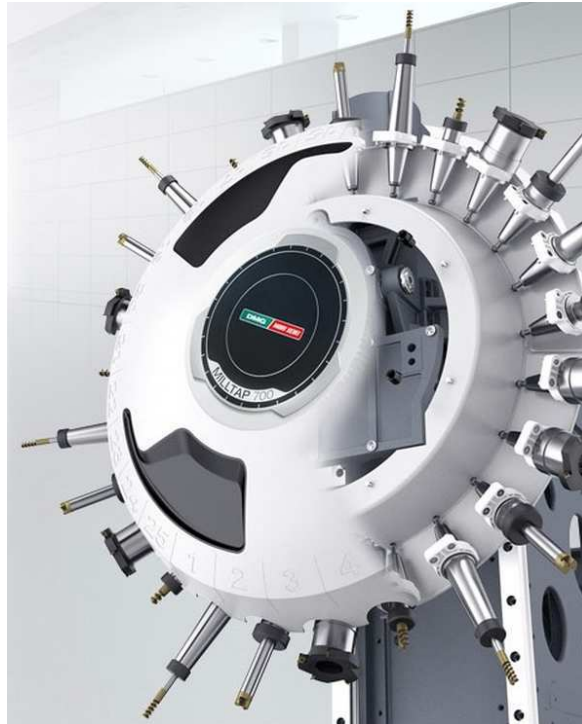
Obr. 7 – Revolverový zásobník nástrojů [4]
