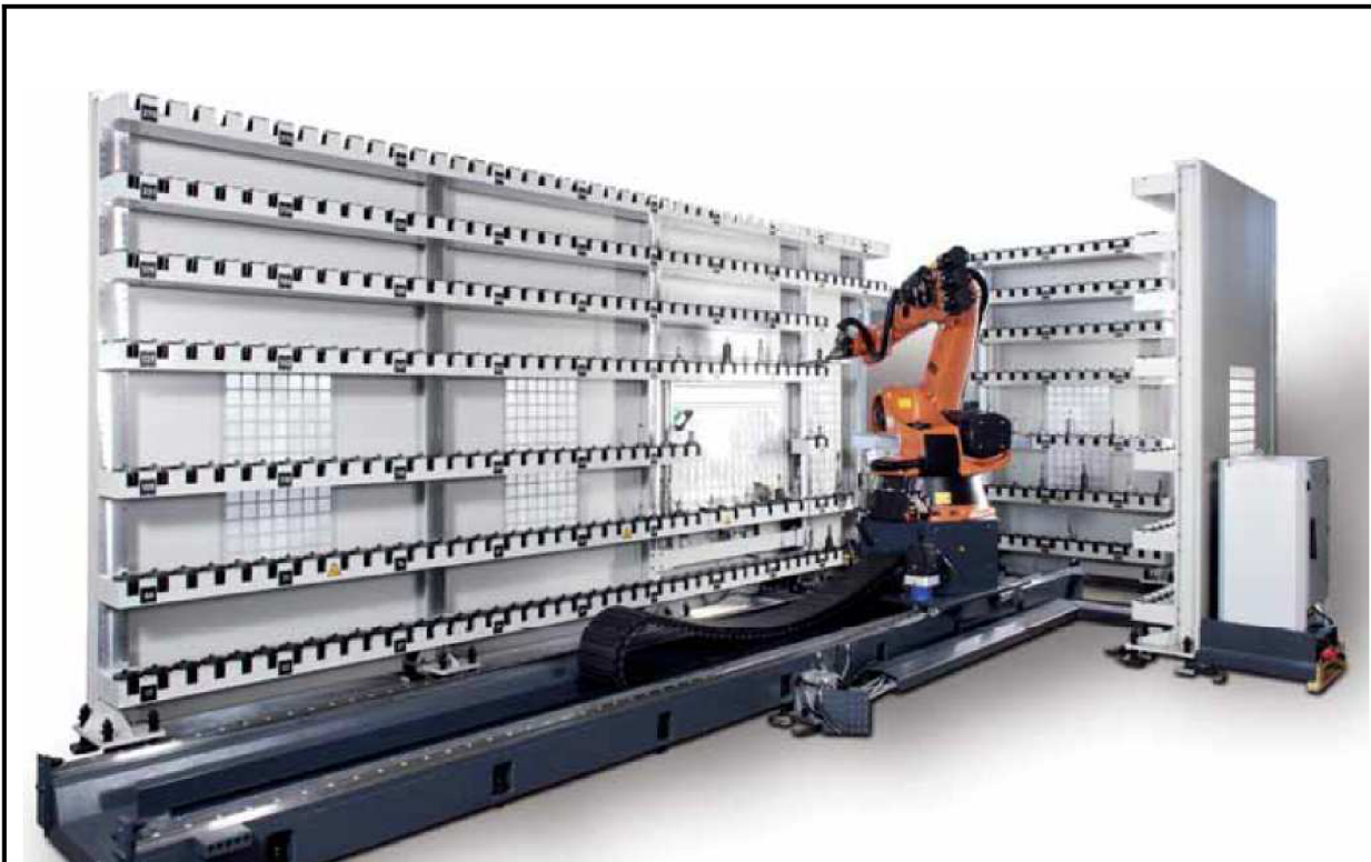
Obr. 14 – Podélný regálový zásobník obsluhovaný průmyslovým robotem s pojezdem [8]
