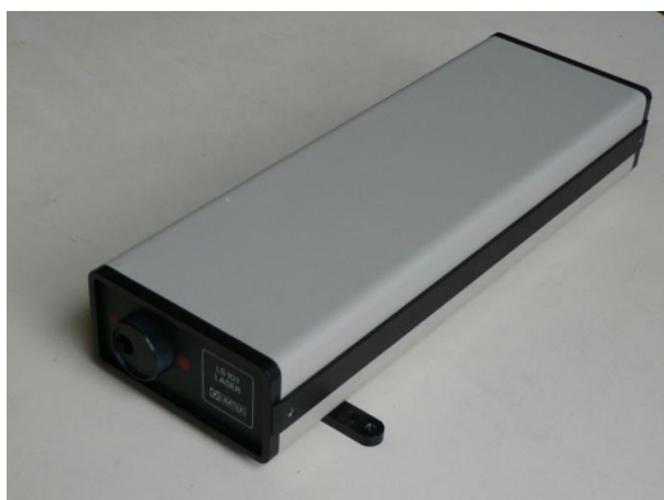
Jednofrekvenční stabilizovaný HeNe laser LS 10.1. Interferometr Meopta MLS 20.
