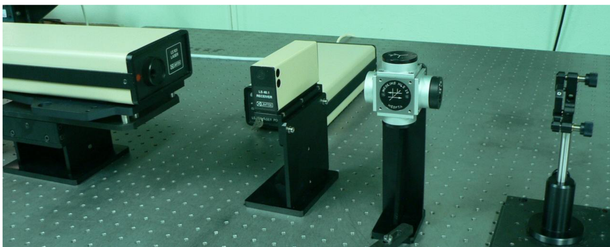
Kompletní sestava interferometru s odrazným zrcátkem. (Fotografie převzaty z manuálu k měřicímu systému Limtek LMS [25].)
