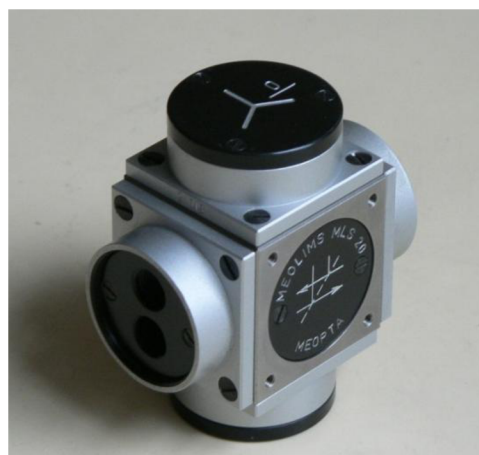
Jednofrekvenční stabilizovaný HeNe laser LS 10.1. Interferometr Meopta MLS 20.
