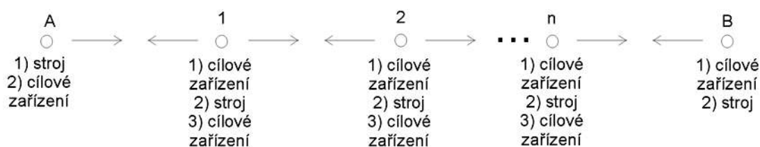
Obr. 21 Princip trig. nivelace – dvakrát měřené převýšení (URL 9)
