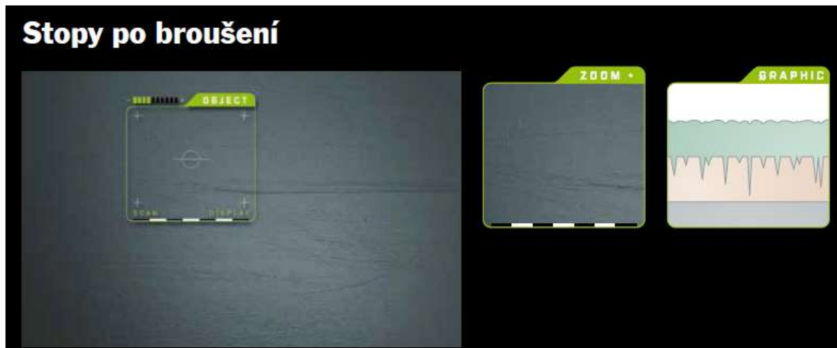
Obr. č. 11 - Stopy po broušení (Standothek, 2015)
