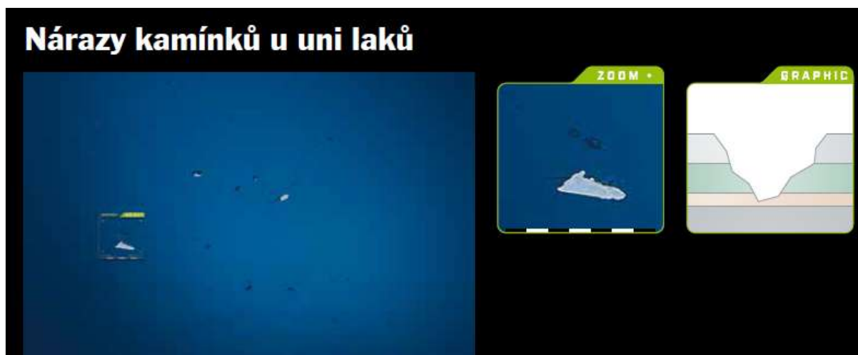
Obr. č. 25 - Stopy po nárazech kamínků (Standothek, 2015)
