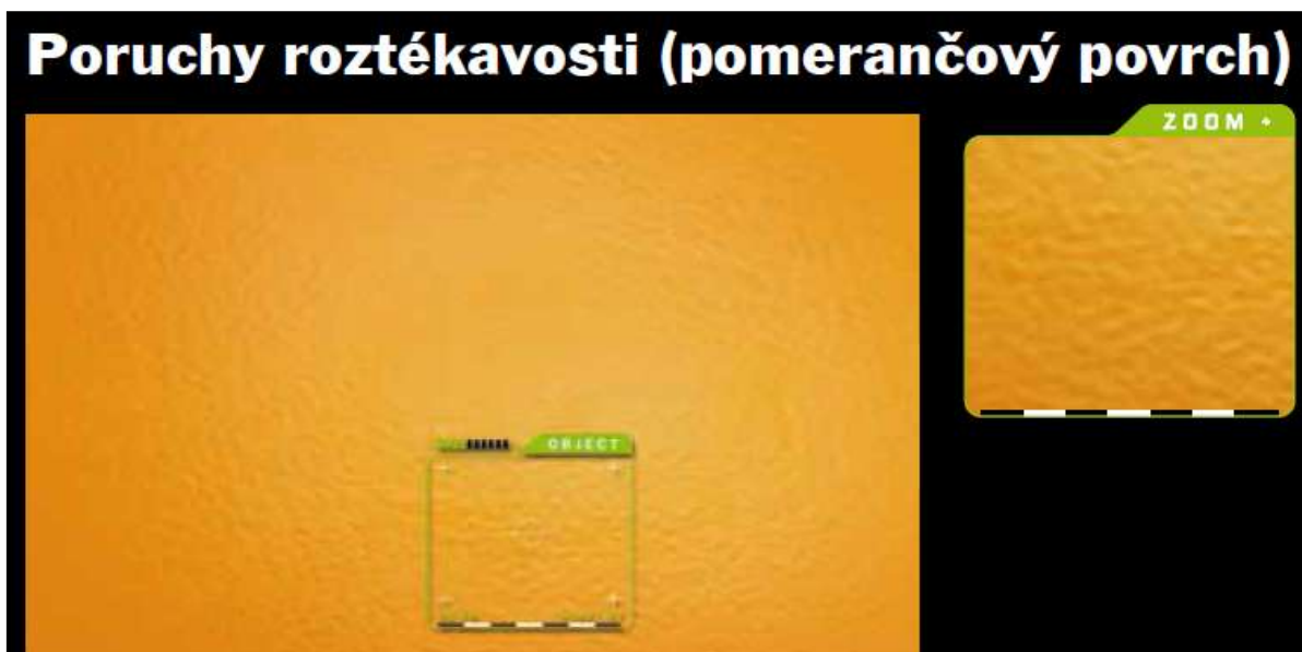
Obr. č. 7 - Pomerančový povrch (Standothek, 2015)
