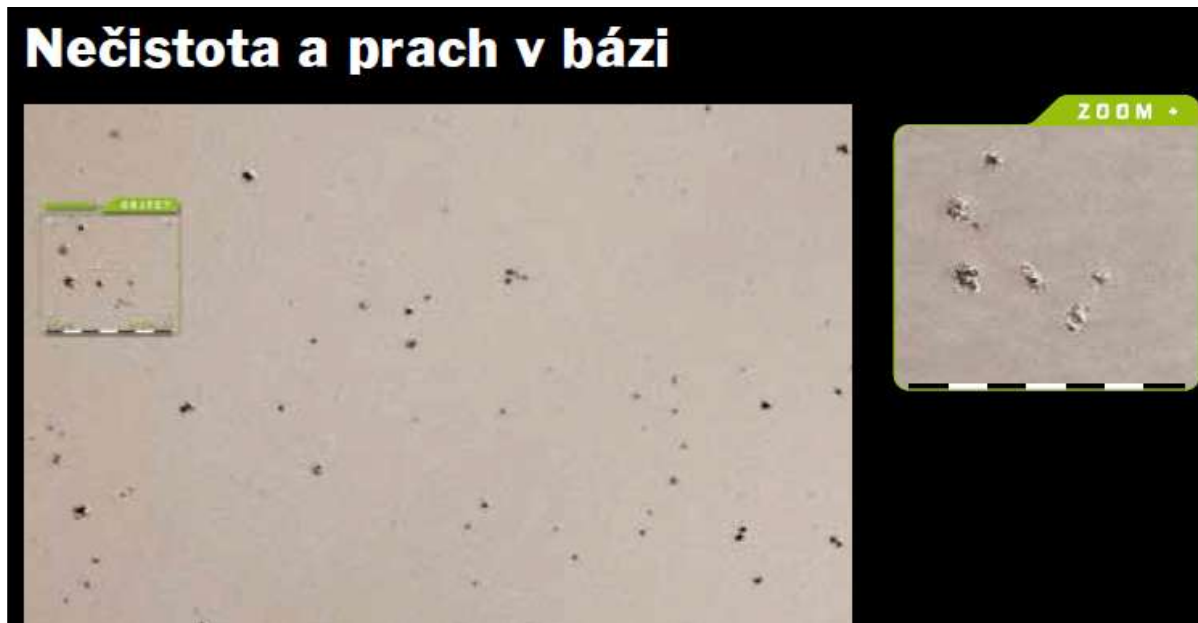
Obr. č. 5 - Nečistota a prach v bázi (Standothek, 2015)
