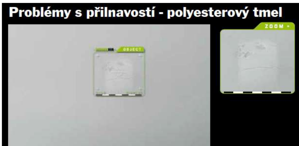
Obr. č. 8 - Problém s přilnavostí polyesterového tmelu (Standothek, 2015)
