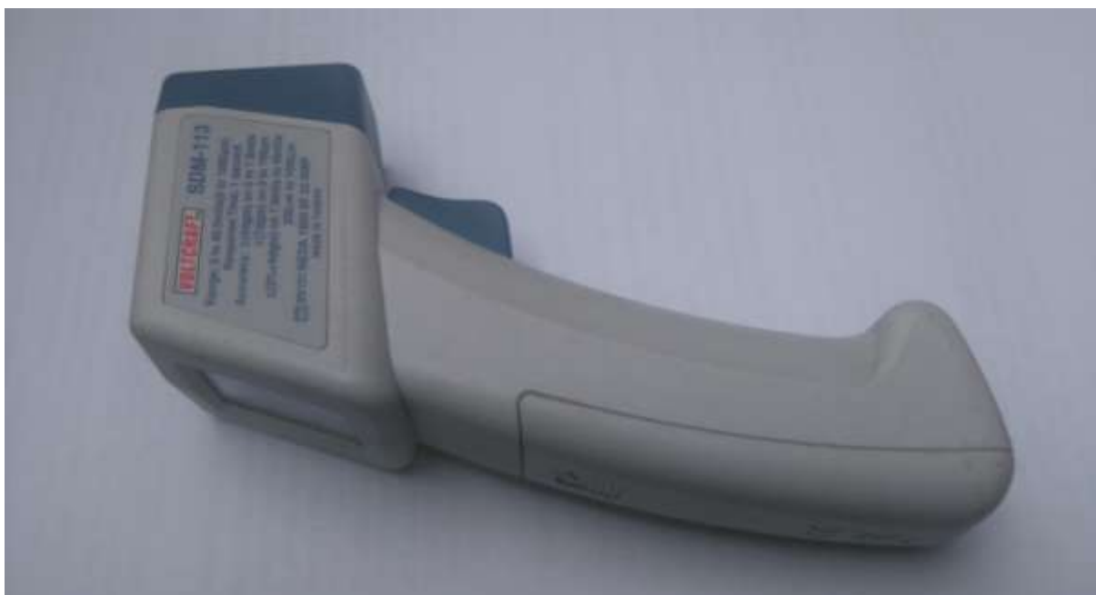
Obr. č. 43 - Měřicí zařízení na tloušťku laku Voltcraft SDM-113 (vlastní zdroj)
