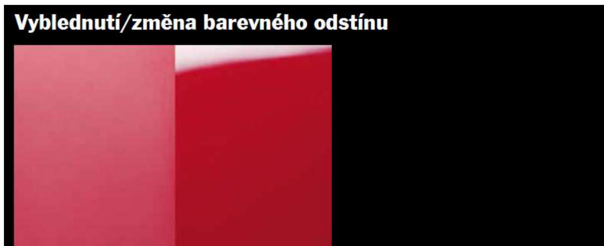
Obr. č. 33 - Vyblednutí (Standothek, 2015)
