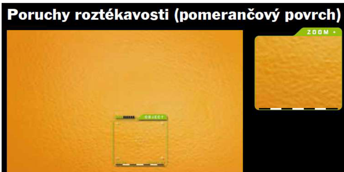
Obr. č. 7 - Pomerančový povrch (Standothek, 2015)
