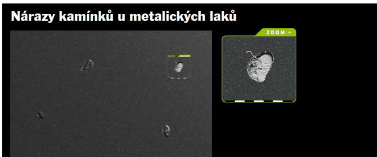
Obr. č. 24 - Stopy po nárazech kamínků (Standothek, 2015)
