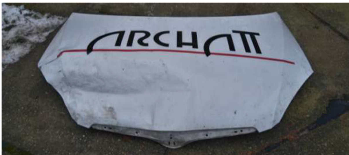
Obr. č. 37 - Rozsah poškození kapoty Škody Roomster (vlastní zdroj)
