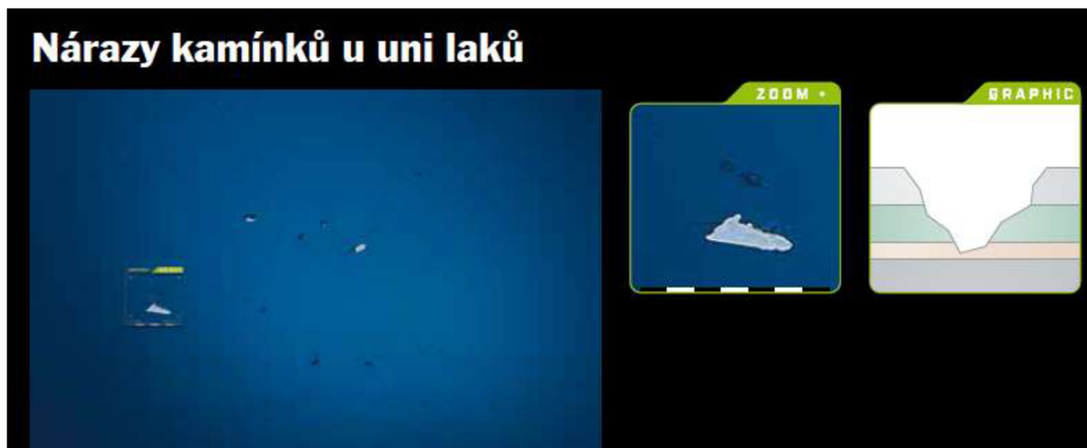
Obr. č. 25 - Stopy po nárazech kamínků (Standothek, 2015)
