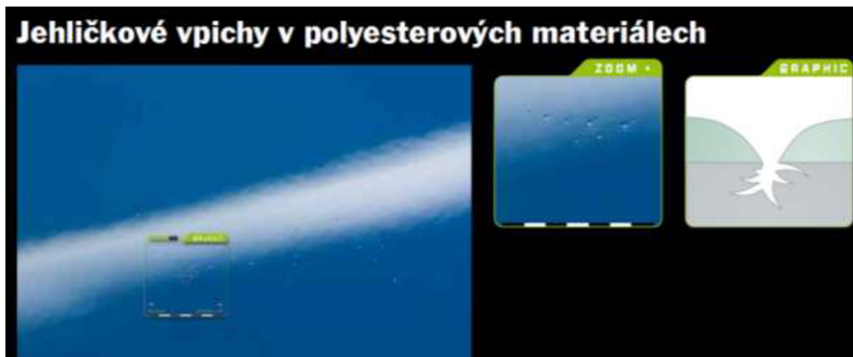
Obr. č. 3 - Jehličkové vpichy v polyesterových materiálech (Standothek, 2015)
