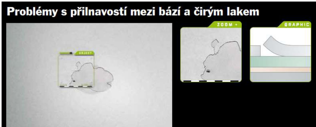
Obr. č. 9 - Problém s přilnavostí mezi bází a čirým lakem (Standothek, 2015)
