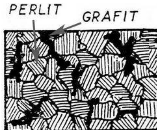
Obr. 8: Litina s červíkovitým grafitem s perlitickou matricí [21]
