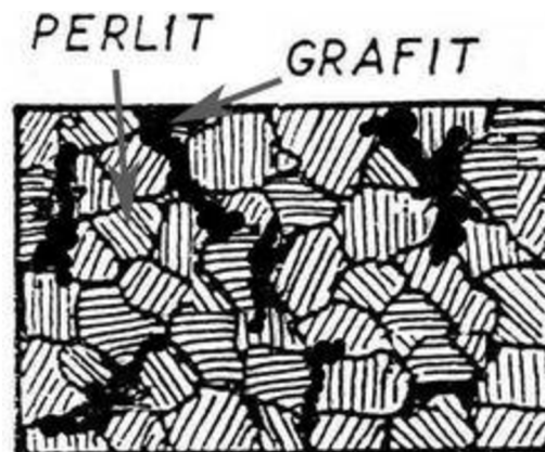
Obr. 8: Litina s červíkovitým grafitem s perlitickou matricí [21]
