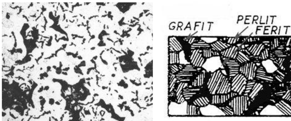
Obr. 9: Litina s červíkovitým grafitem s feriticko - perlitickou matricí [21]
