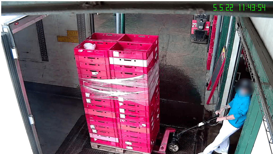
Obrázek 2.1: Příklad vstupu. Zde lze vidět odrazy fólií, degradovanou barvu přepravků, nálepky na různých pozicích. I bez značného přiblížení lze pozorovat různé artefakty způsobené kompresí.
