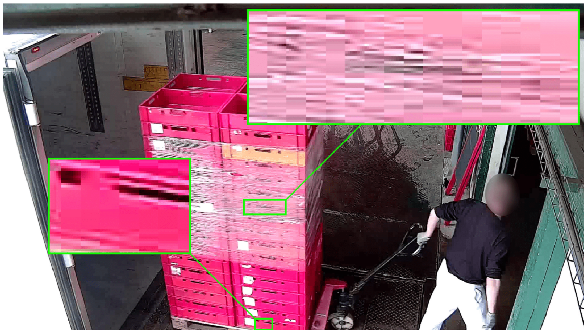
Obrázek 2.2: Detail vstupního snímku s přiblíženými oblastmi snímku. V horním přiblížení nelze bez kontextu téměř vůbec rozeznat, o jaký objekt se jedná. V dolní části lze vidět části 8 \times 8 či 8 \times 1 pixelů, které se spojují v jeden celek a vytvářejí různé artefakty.
