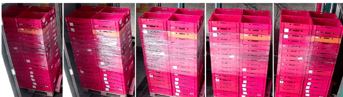
Obrázek 2.10: Sled snímků z videozáznamu, který vyobrazuje odrazy na fólii dle pozice přepravek. V prvním snímku lze jednoduše rozpoznat pravý sloupec s přepravkami, v snímku 2 je v tohle sloupci silný odraz, který téměř znemožňuje spolehlivě detekovat 5 až 8 přepravek. V dalším snímku se tohle opakuje u levého sloupce. Nakonec u posledních dvou snímků není prominentní odraz, a bylo by tedy značně jednodušší zde spolehlivě detekovat přepravky. Snímky byly oříznuty jen na podstatné části obrázku pro lepší čitelnost.
