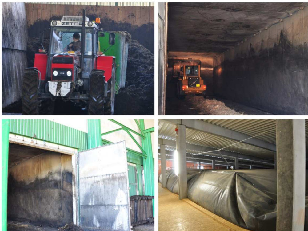
Obr. 6: Technologie BIOFERM: míchání substrátu (vlevo nahoře), navážení substrátu do reaktoru (vpravo nahoře), vzduchotěsná vrata reaktoru v pozadí další reaktor (vlevo dole), plynový vak (vpravo dole)
