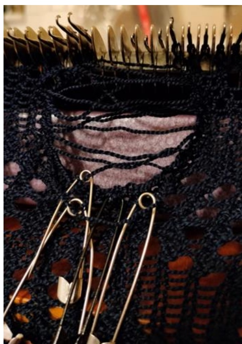
Obrázek 103 Oprava spadlých sloupků před opravou
