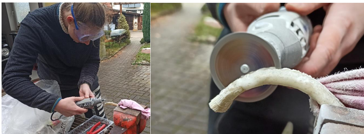
Obrázek 66 Příprava vzorků pro optický a elektronový mikroskop
