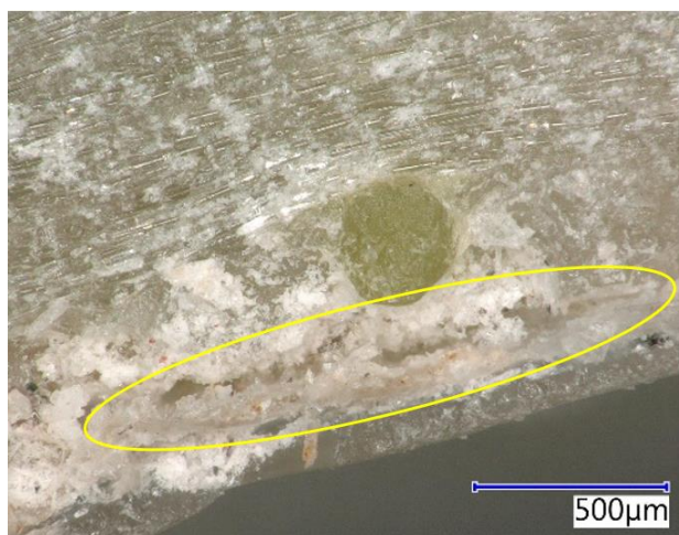
Obrázek 83 Detail podélného řezu vnitřní strany ohybu třmínku uloženého 1000 h ve vodě při 20 °C, 200x zvětšeno
