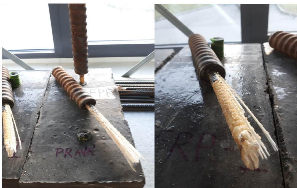
Obrázek 53 Typické porušení na začátku ohybu + delaminace v přímé části u vzorku U-konfigurace (vlevo) a L-konfigurace (vpravo)
