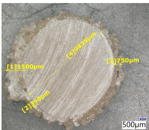
Obrázek 71 Příčný řez třmínkem uložným 1000 h ve vodě při 20 °C – přímá část, 20x zvětšeno
