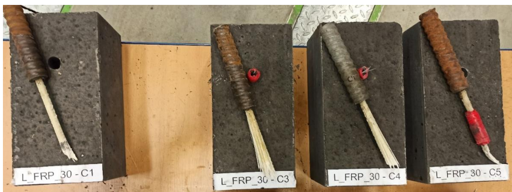
Obrázek 61 Správné porušení vzorků VI. sady – selhání v ohýbané části + delaminace
