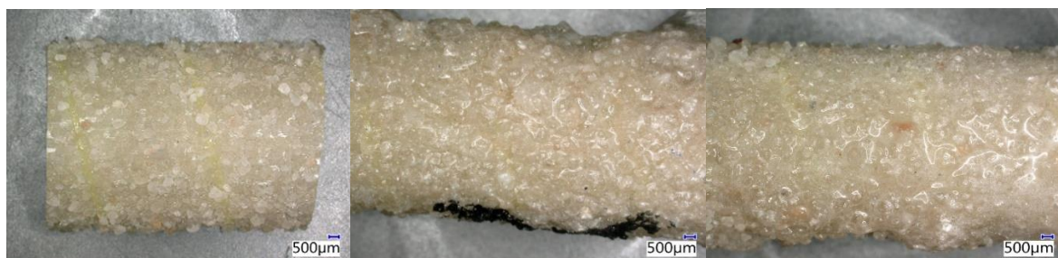
Obrázek 77 Snímky povrchu přímých prutů po 1000 h, zleva: referenční (na vzduchu), ve vodě při 20 °C a v alkalickém roztoku při 40 °C, 20x zvětšeno
