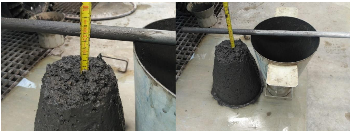
Obrázek 47 Zkouška sednutí kužele
