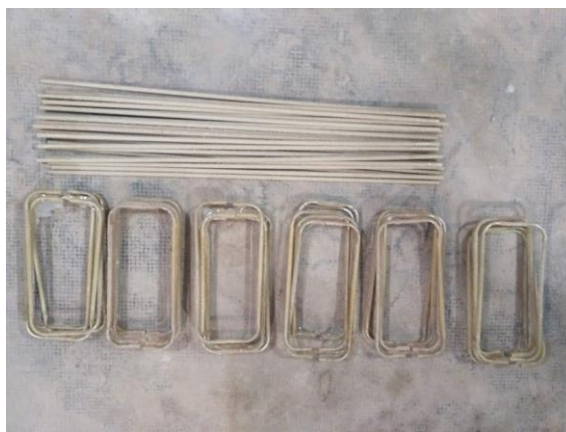
Obrázek 48 Vzorky GFRP před uložením do agresivních prostředí
