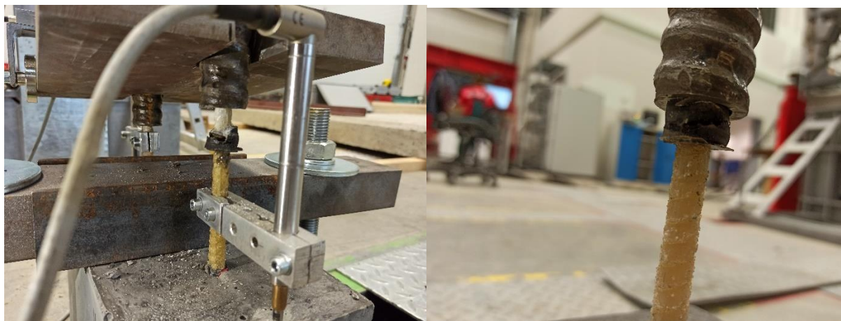
Obrázek 52 Selhání vzorků prokluzem výztuže v upínací koncovce
