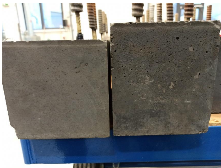
Obrázek 56 Porovnání výšky vzorku po 30denní expozici (vlevo) se vzorkem z předešlé sady (vpravo)
