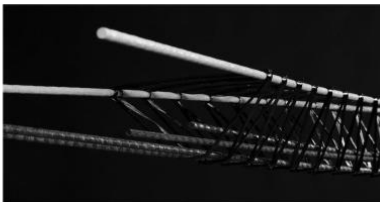
Obrázek 11 Armokoš vyrobený vinutím třmíneků kolem přímých prutů [10]
