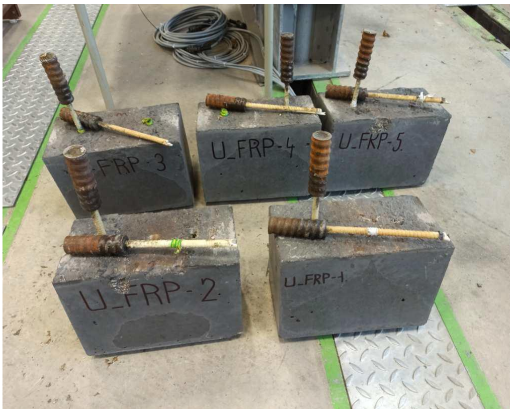
Obrázek 50 Vzorky po zkoušce pevnosti v tahu ohýbaných částí – I. sada: referenční vzorky (uložení na vzduchu v laboratorním prostředí 20 °C), U-konfigurace
