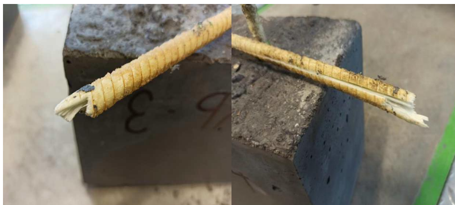
Obrázek 51 Typické porušení na začátku ohybu (vlevo), delaminace přímé části prutu u vzorku U_FRP-4 (vpravo)
