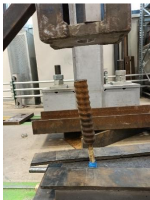
Obrázek 59 Vzorek B3 před zatěžováním – vychýlení výztuže v podélném směru
