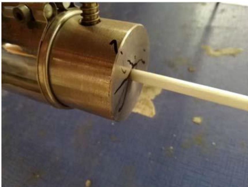
Obrázek 13 Pultruze prutu ze skleněných vláken a pryskyřice Elium [13]
