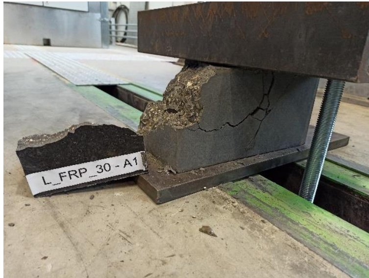
Obrázek 55 Porušení vzorku vyčerpáním tahové únosnosti betonu
