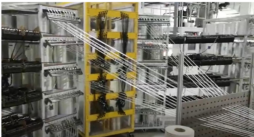
Obrázek 2 Zásobník rovingů a navádění vláken [3]
