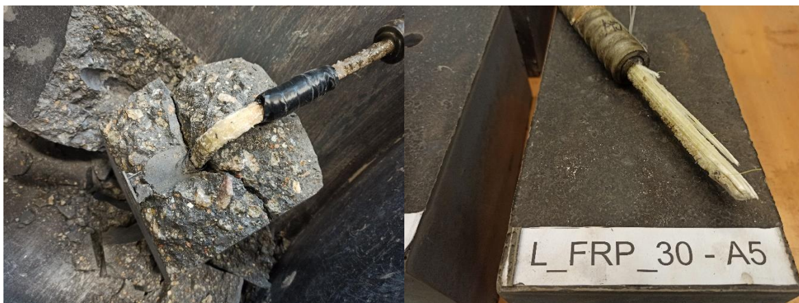
Obrázek 58 Příkladů porušení vzorků IV. sady: vzorek A1 – porušení betonu (vlevo), vzorek A5 – porušení FRP výztuže v ohybu + delaminace (vpravo)
