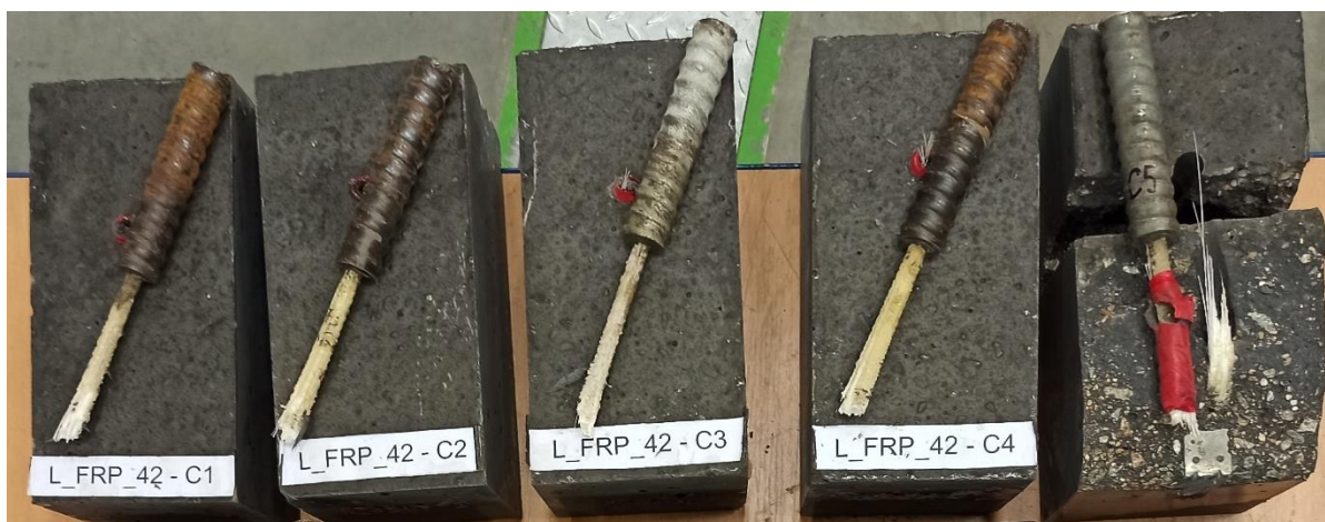
Obrázek 65 Porušení vzorků IX. sady
