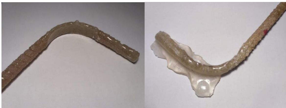
Obrázek 76 Ohyby třmínek po vystavení po dobu 1000 h vodě při 20 °C (vlevo) a v alkalickém roztoku při 40 °C (vpravo)
