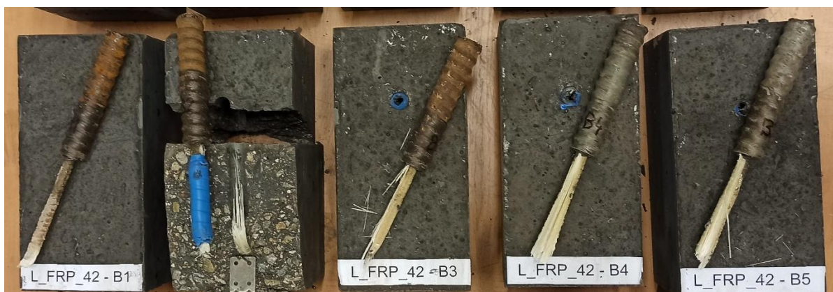
Obrázek 64 Porušení vzorků VIII. sady
