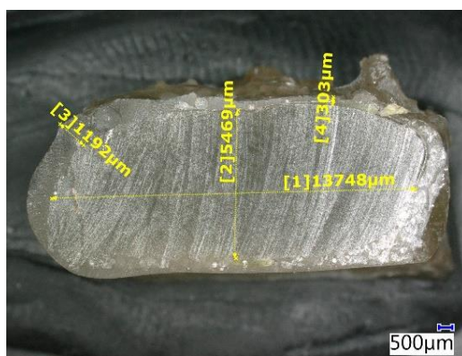
Obrázek 73 Příčný řez třmínkem uložným 1000 h ve vodě při 20 °C – ohyb, 20x zvětšeno
