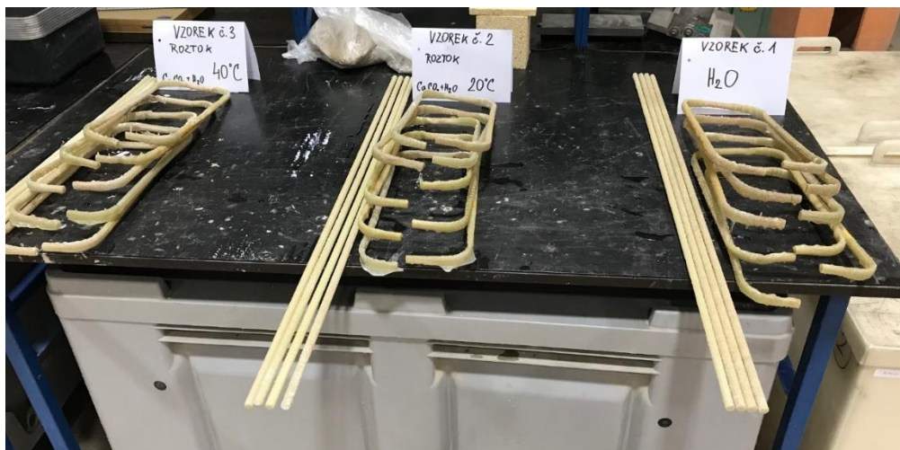
Obrázek 54 Vyjmuté a opláchnuté vzorky po 30 dnech v agresivním prostředí
