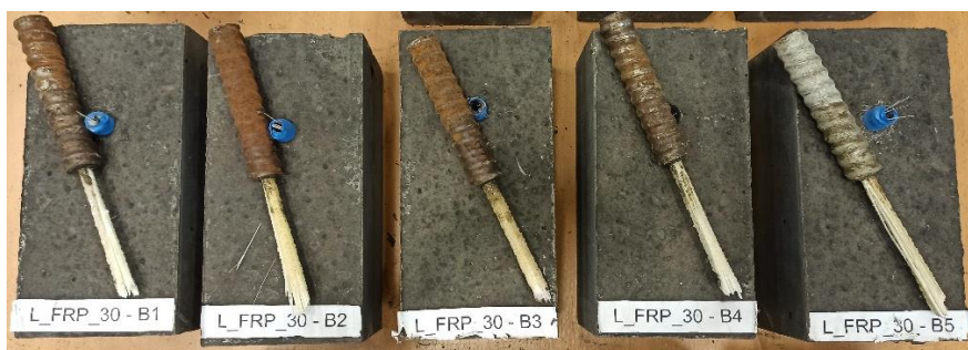
Obrázek 60 Porušení vzorků V. sady – selhání v ohýbané části + delaminace
