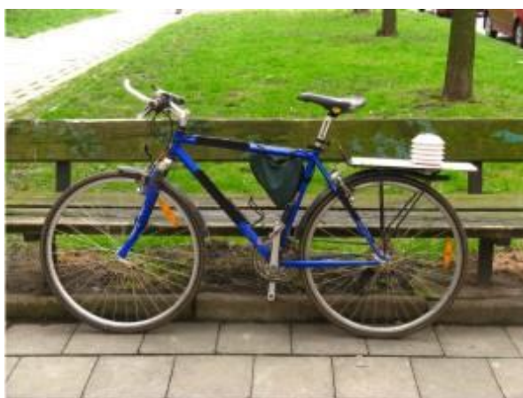
Obr. 2 Umístění radiačního krytu na nosiči kola
