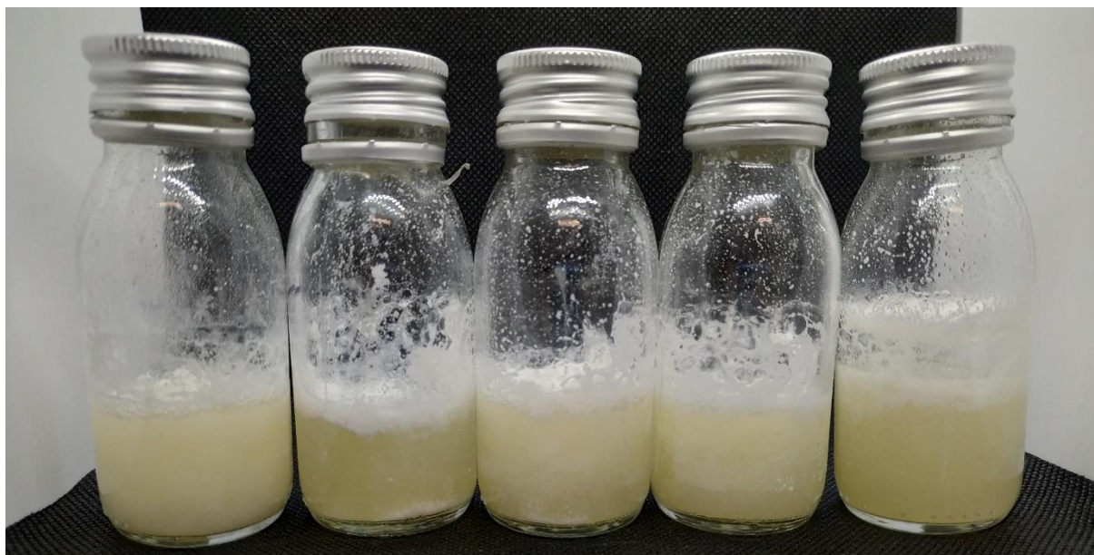
Obrázek 18 - Ukončená produkce 3D BC v napěněném médiu po 14 dnech
