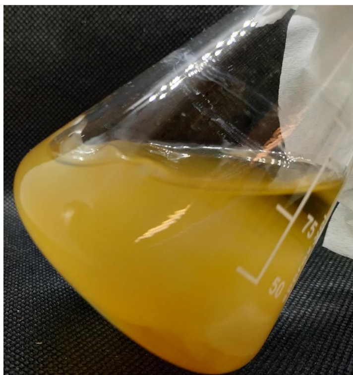
Obrázek 20 - Výsledek fedbatch produkce 3D vzorku v médiu s přidavkem polyvinylalkoholu
