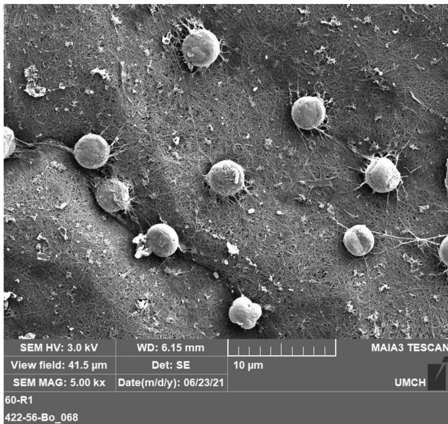
Obrázek 23 - Struktura 3D vzorku s PVA při různém přiblížení SEM
