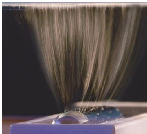
Obr. 3.3: Zvlákňování z válce (Nanospider) (Lin 2011)
