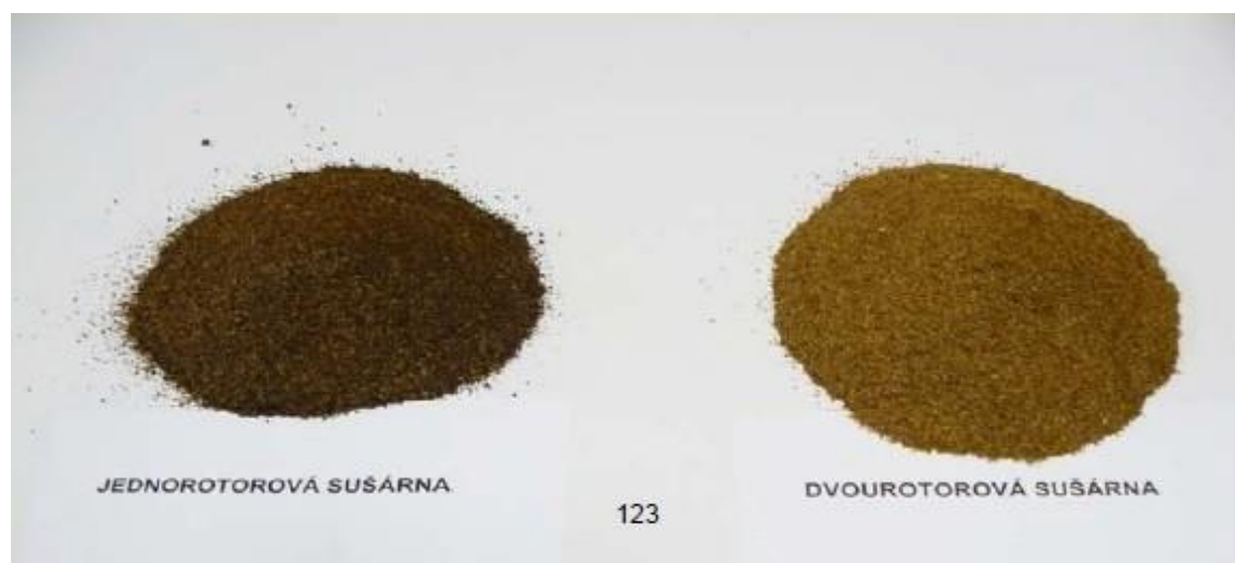
Obrázek 4: Porovnání biopaliv z jednorotorové a dvourotorové pece; Zdroj: http://biom.cz/cz/obrazek/obr-srovnani-dvorotorove-susarny-s-jednorotorovou-susarnou
