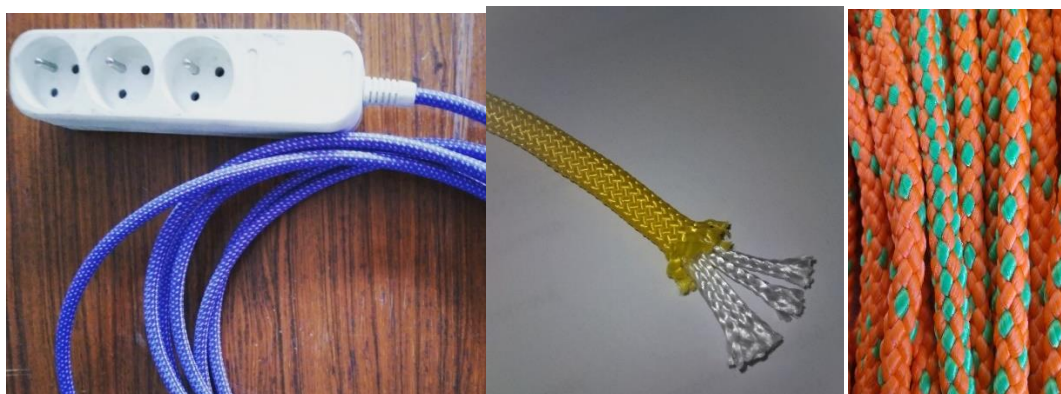
Obrázek 6. Oplet a) jádro kabel 3x0,75, b) jádro čtyři šňůry, c) bez výplně
