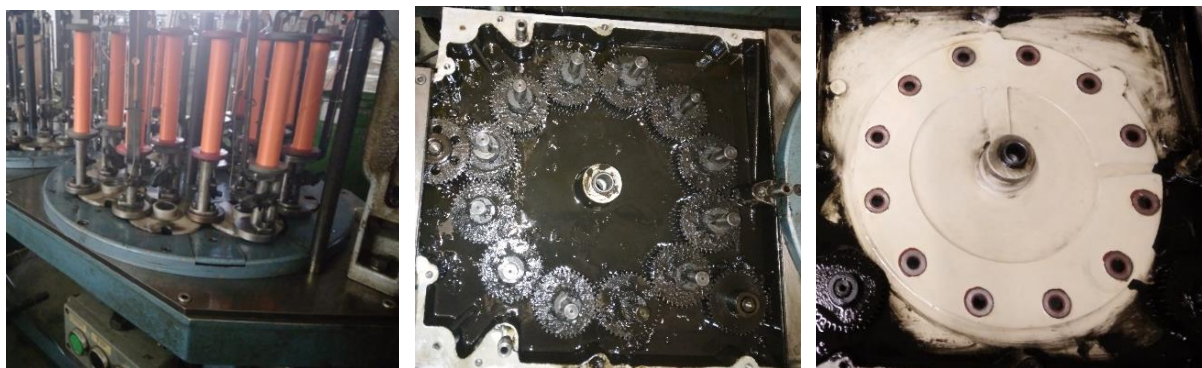
Obrázek 9. Olejová vana vlevo se soukolím a)zvenku, b)uvnitř, c)bez soukolí
