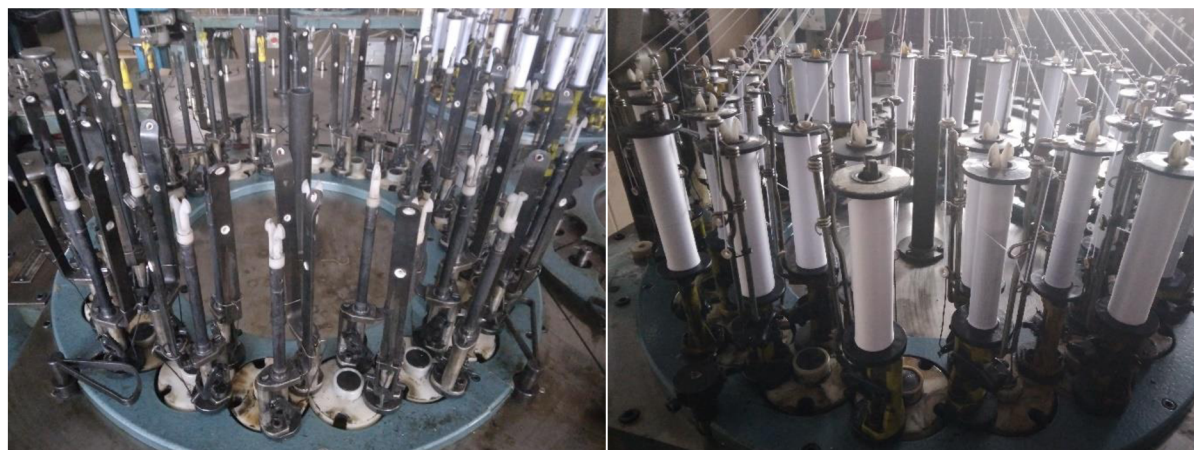
a) b) Obrázek 12. PSJ 40 a) s prázdnými paličkami, b) s návlekem
