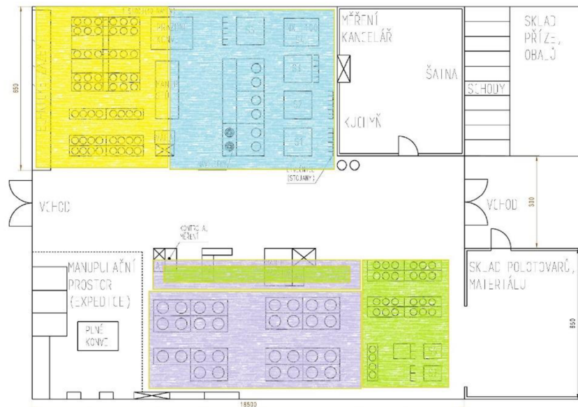
Obrázek 32. Nové úseky toku materiálu po optimalizaci pracoviště
