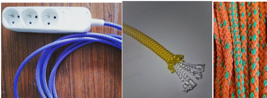
Obrázek 6. Oplet a) jádro kabel 3x0,75, b) jádro čtyřech šňůr, c) bez výplně
