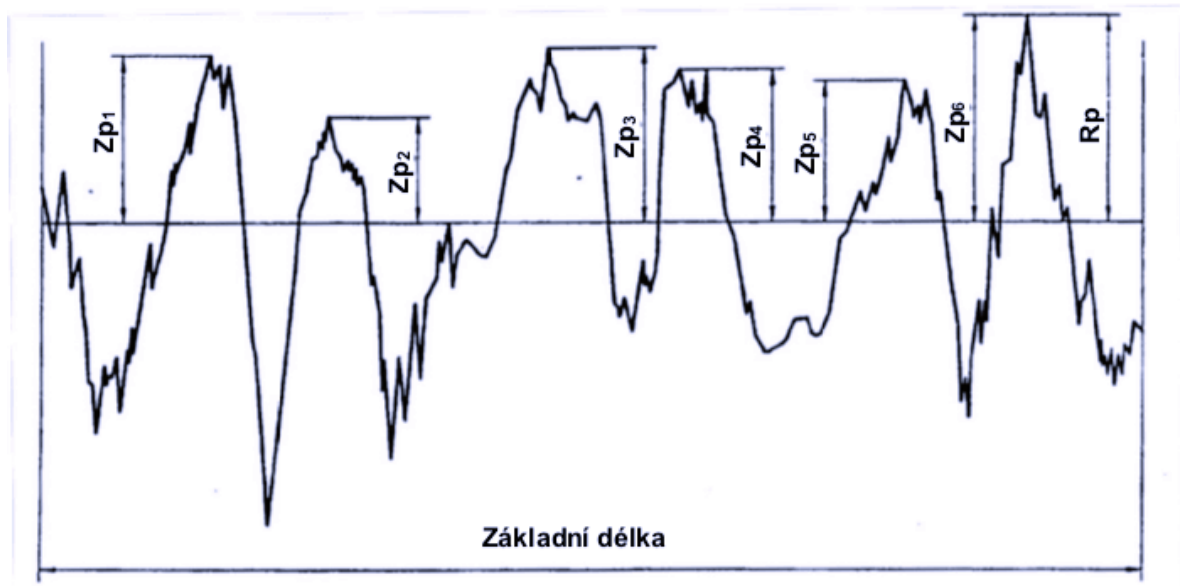
Obrázek 15 Největší výška výstupků profilu (ČSN EN ISO 4287)
