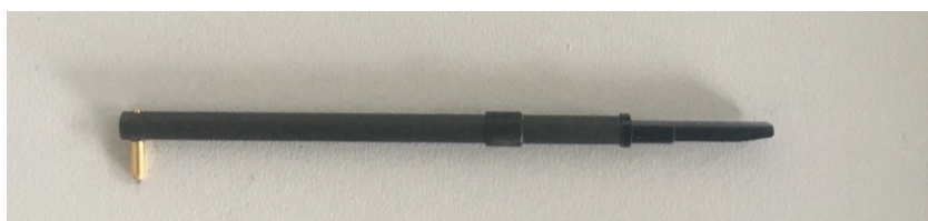
Obrázek 28 Snímací raménko s diamantovým hrotem
