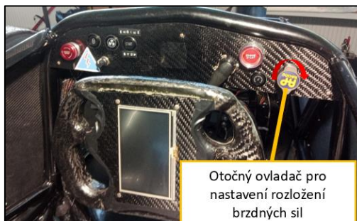
Obrázek 56 Otočný ovladač vahadla brzdných sil [Archiv týmu CULS Prague Formula Racing]
