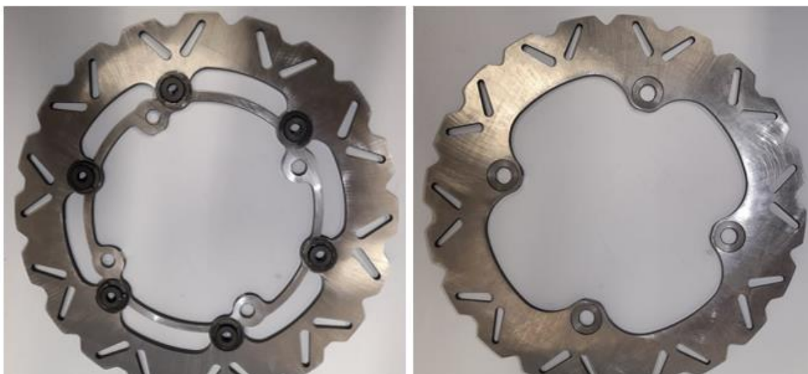
Obrázek 37 Přední a zadní brzdové kotouče vyrobené firmou Motokotouce.cz [Archiv autora ]
