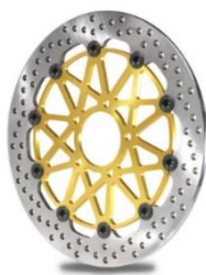
Obrázek 19 Plovoucí brzdový kotouč[12]
