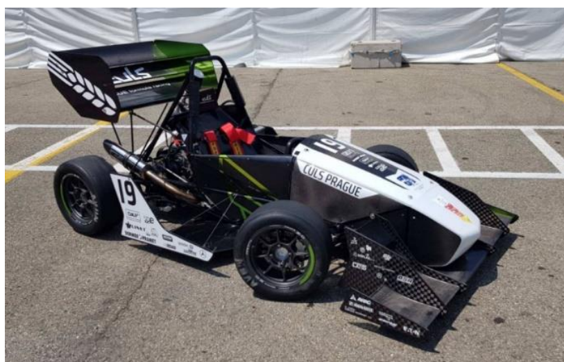
Obrázek 32 Monopost FS05 s disky z hořčkové slitiny OZ Racing [Archiv autora ]
