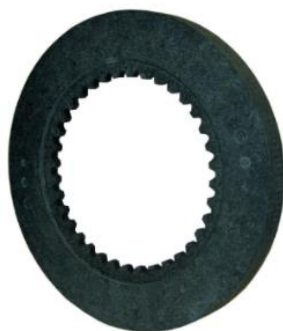
Obrázek 17 Brzdový kotouč z uhlíkového kompozitu[11]
