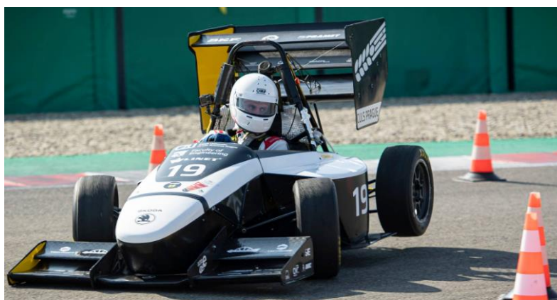
Obrázek 28 Monopost FS06 při průjezdu levotočivou zatáčkou - vitelný přenos zatížení na pravé vnější kolo [Archiv týmu CULS Prague Formula Racing]
