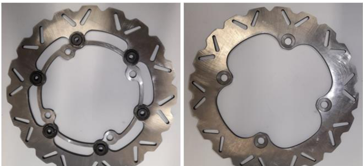
Obrázek 37 Přední a zadní brzdové kotouče vyrobené firmou Motokotouce.cz [Archiv autora ]
