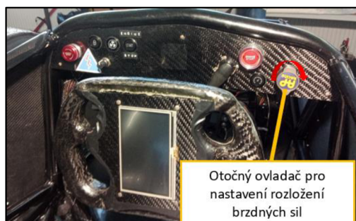
Obrázek 56 Otočný ovladač vahadla brzdných sil [Archiv týmu CULS Prague Formula Racing]
