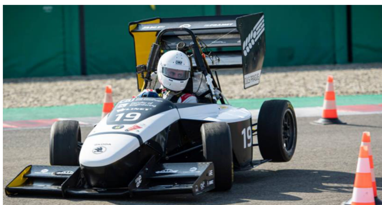
Obrázek 28 Monopost FS06 při průjezdu levotočivou zatáčkou - vitelný přenos zatížení na pravě vnější kolo [Archiv týmu CULS Prague Formula Racing]
