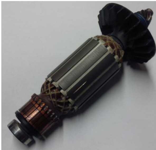
Obr. 5.1 Rotor střídavého komutátorového motoru úhlové brusky
