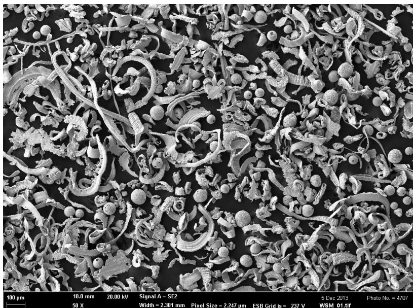
Obr. 3.12 Prachové částice vznikající při použití kotouče WSM
