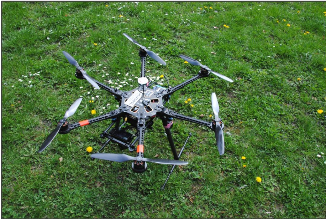
Obr. 18 Spreading Wings S800, fotografie použitého UAV.
