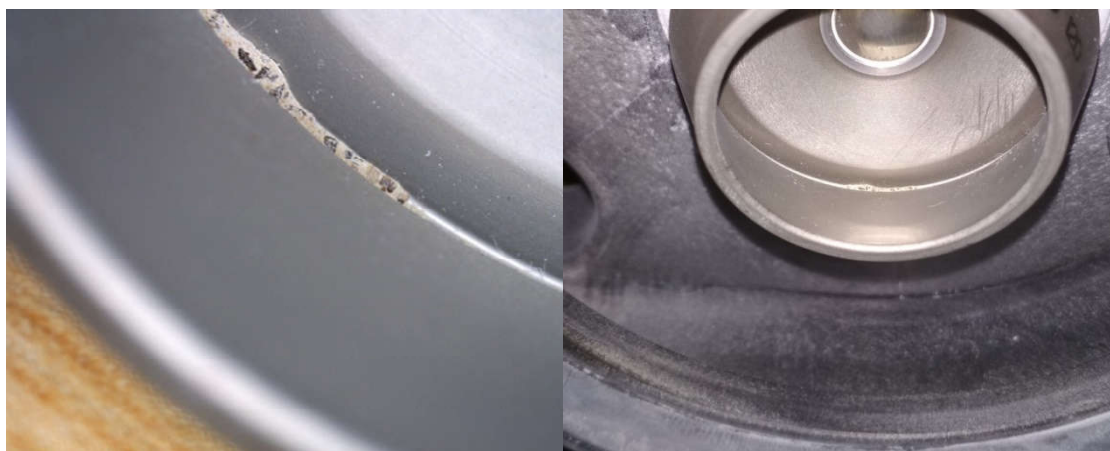
Obr. (15) Detail zanesené drážky rotoru
