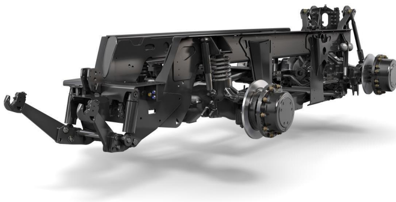
Obr.2 Rámová konštrukcia podvozku JCB Fastrac 8000 [22]
