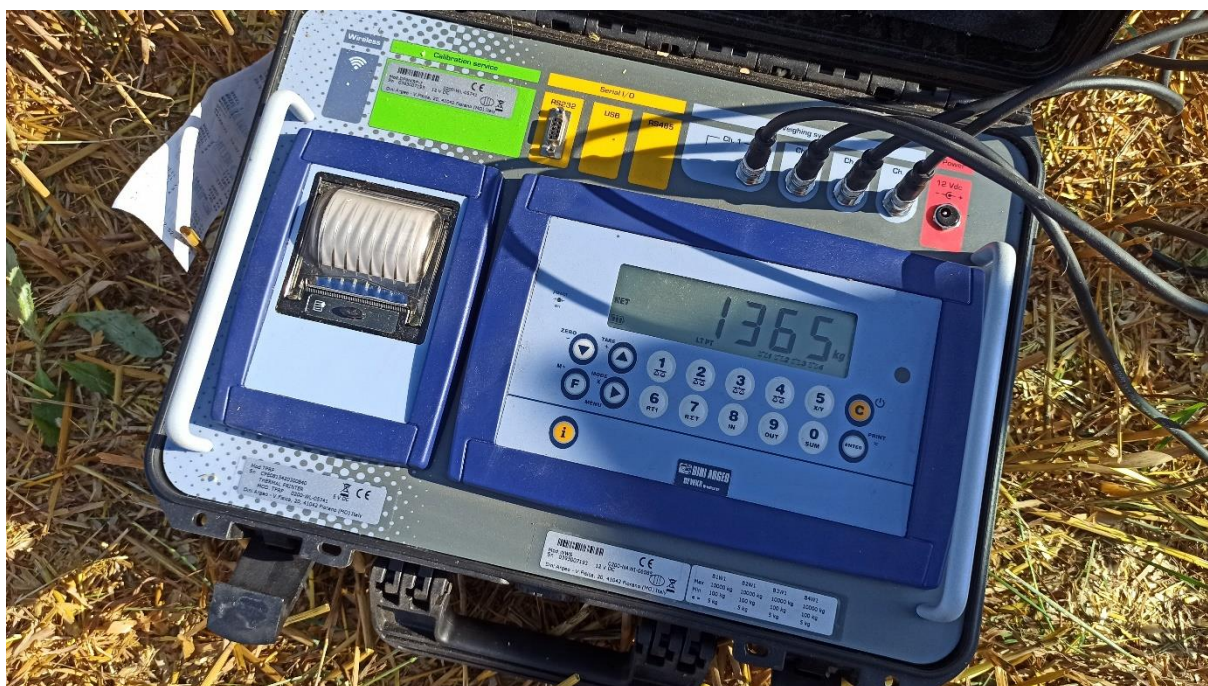
Obrázek 7: Pro zjištění výnosu z každé varianty byl na poli přistaven valník s nájezdovými vahami.
