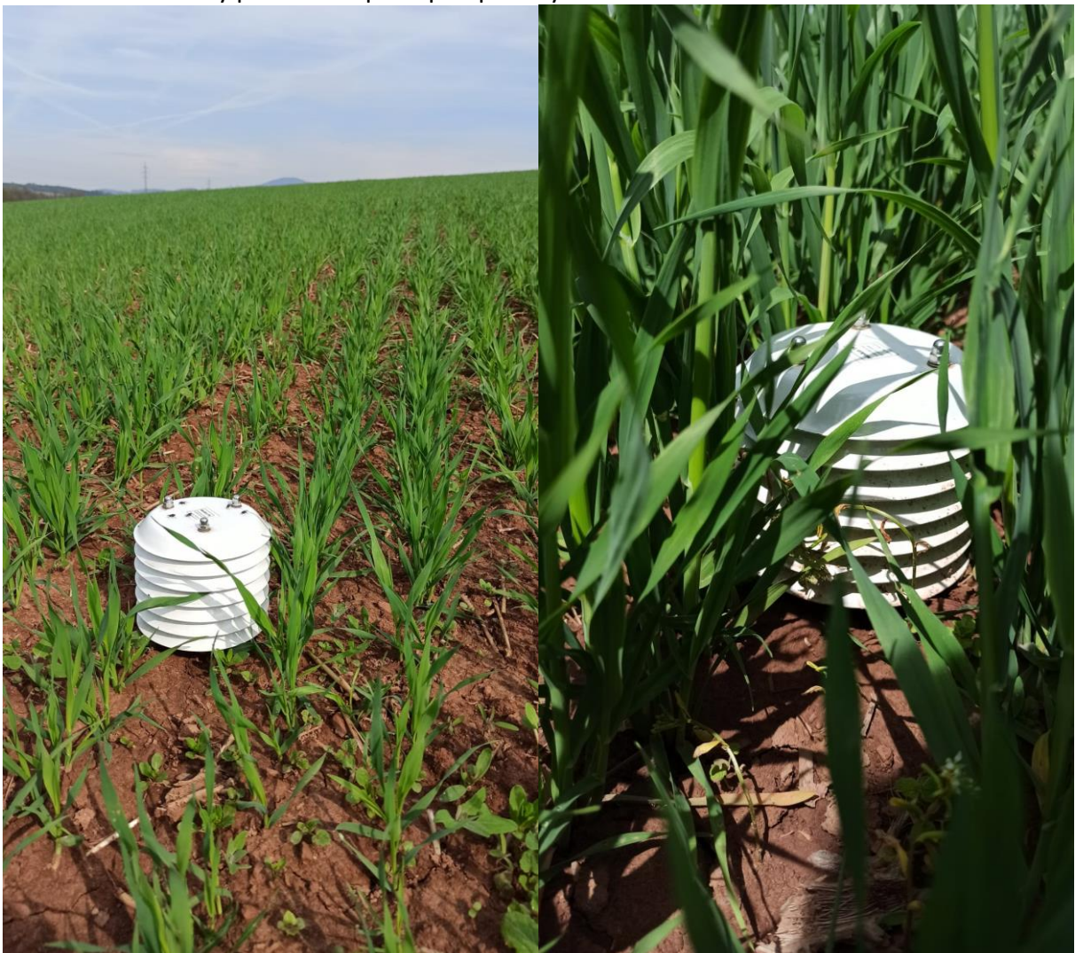
Obrázek 4 (11. 5. 2022) a 5 (31. 5. 2022) – čidla pro měření teploty a vlhkosti v porostu
