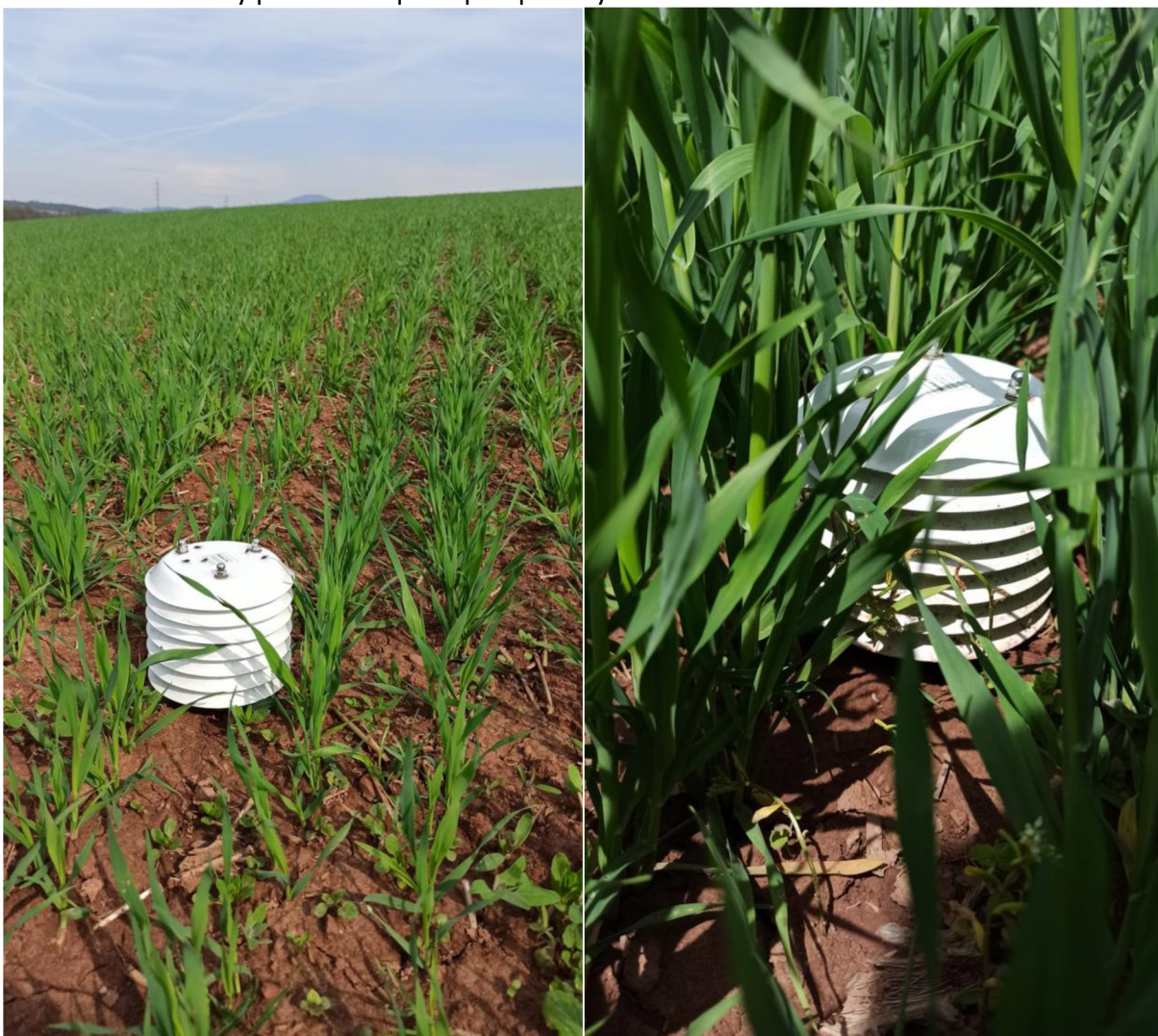
Obrázek 4 (11. 5. 2022) a 5 (31. 5. 2022) – čidla pro měření teploty a vlhkosti v porostu
