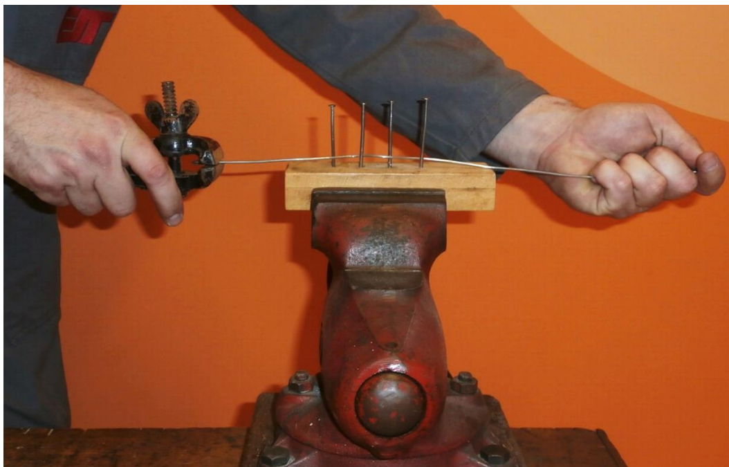
Obr. č. 29: Rovnání drátu v hřebíkovém hřebenu
