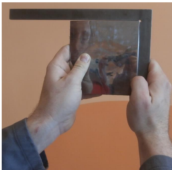
Obr. č. 10: Kontrola kolmosti
