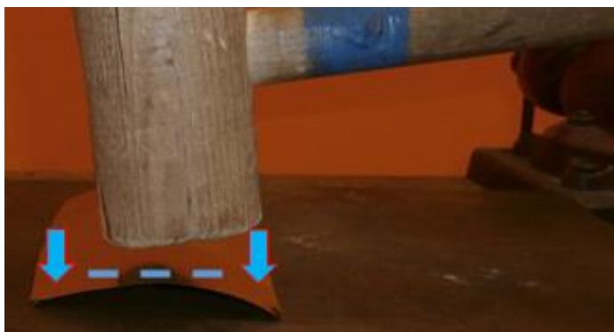
Obr. č. 39: Vyrovnávání ohnutých okrajů
