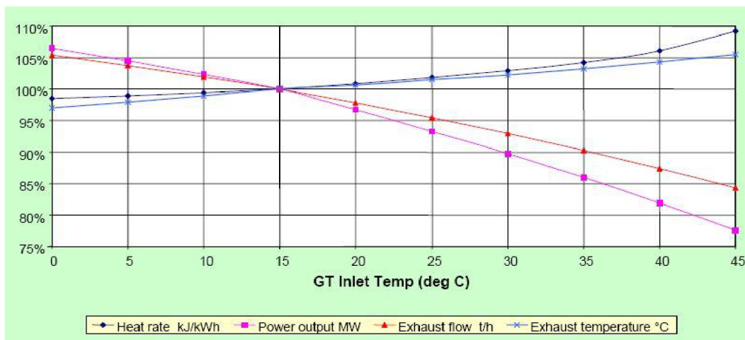
Obr. 5 Závislosť mernej spotreby tepla, výkonu, prietoku a teploty spalín priemyselných turbín na okolitej teplote
